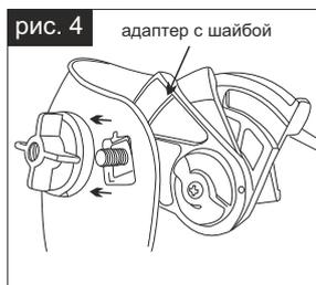
Открутите гайку адаптера, установите адаптер с шайбой с внутренней стороны корпуса щитка в отверстие, соблюдая положение левого адаптера (L) с левой частью корпуса, правого адаптера (R) - с правой частью корпуса (рис. 4).
