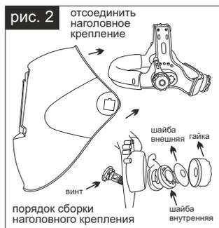
Соберите разобранную часть наголовного крепления с внутренней и внешней шайбами, зафиксируйте гайкой (рис. 2). Повторите действия с другой стороной наголовного крепления. Уберите в сторону наголовное крепление для повторного использования.
