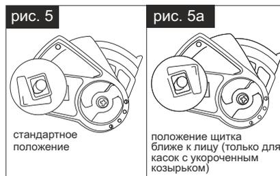
По умолчанию адаптеры поставляются в стандартном положении шайбы (рис. 5). При необходимости размещения щитка ближе к лицу (для касок с укороченным козырьком: СОМЗ-55 ВИЗИОН, СОМЗ-55 Hammer, RFI-3 BIOT, СОМЗ-78 Эльбрус) переверните шайбы на 180°С (рис. 5а) и соберите со щитком, зафиксируйте гайками.
